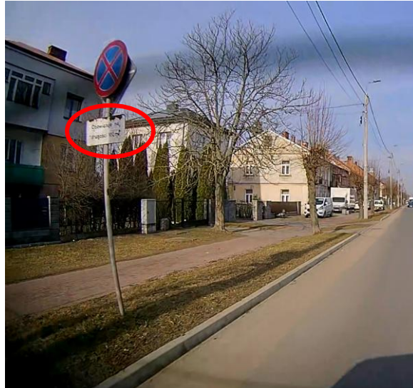
Zdjęcie 22: Brak czytelności tabliczki pod tarczą znaku B-36 Źródło: własne.
